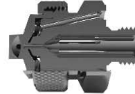
外部混合 (压力装置) 扇形喷雾
